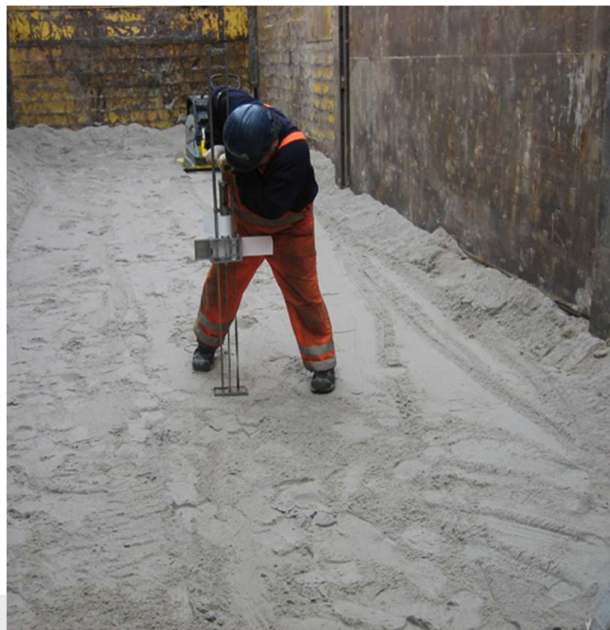
Foto: Voorbeeld van een controlemeting van de indringingsweerstand.
